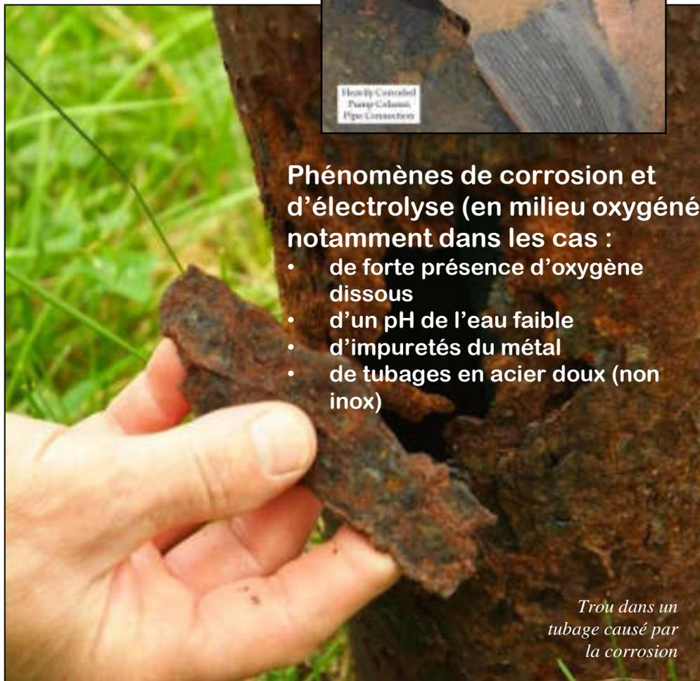
Phénomènes de corrosion et d'électrolyse (en milieu oxygéné) notamment dans les cas :
