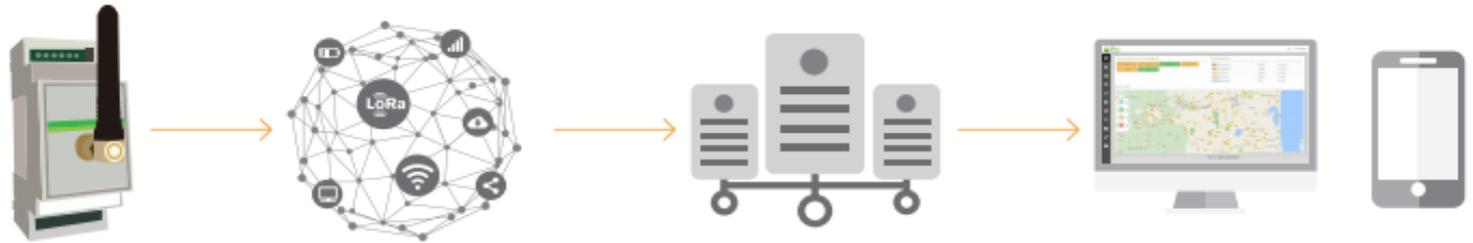
**Une horloge astronomique connectée LoRa permet un pilotage simple, intuitif et en temps réel des installations d'éclairage public, via une communication bas débit et longue distance.**
